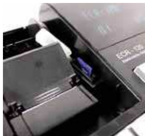
Durch den eingebauten SD-Kartenslot ist die ECR-120 in der Lage, alle Geschäftsvorfälle entsprechend der Einzelaufzeichnungs- und Aufbewahrungspflicht zu speichern. Die gesetzlichen Vorgaben werden mit diesem Modell vollumfänglich erfüllt.
